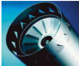
Moderner Delta Brennkopf für Gasbrenner mit interner Abgasrezirkulation: 1 Luft 2 Brenngas 3 Heizflamme 4 Gasschichtströmung 5 Abgasrückführung
