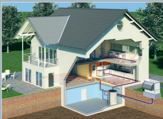
Installazione esterna di una termopompa AEROTOP® T di ELCO
