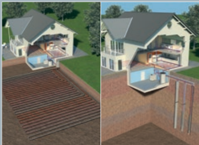
Sfruttamento geotermico mediante collettori
