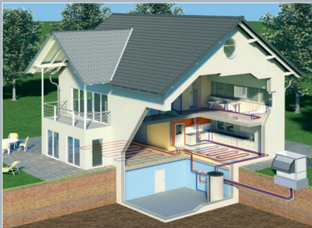
Installation d'une pompe à chaleur AEROTOP® T de ELCO à l'extérieur
