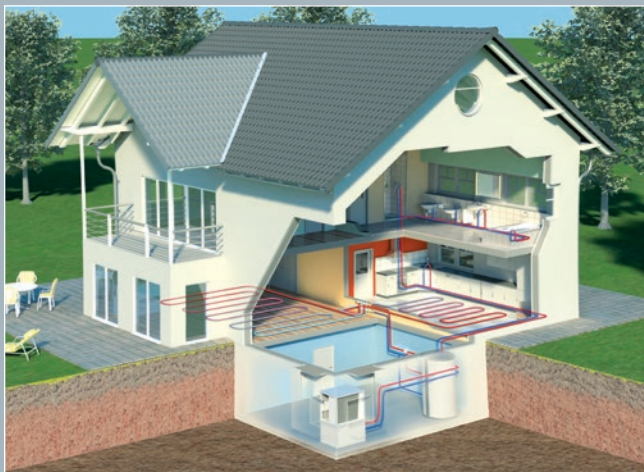
Installation d'une pompe à chaleur AEROTOP® T de ELCO à l'intérieur
