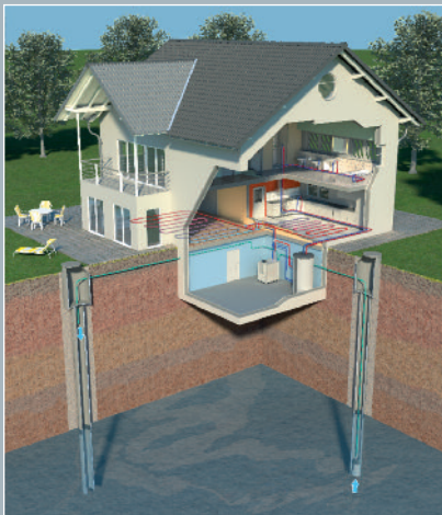
Energiegewinnung aus Grundwasser
